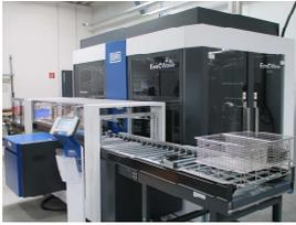
Heißlufttrocknung bis 130°C, Vakuumtrocknung, Zwischentrocknung, Ultraschallunterstützung beim Reinigen, 360° Warenbewegung in der Arbeitskammer, Aquacleansystem mit Kondensatölabscheider zur Spülbadauflbereitung, Vollentsalzungsanlage mit Aktivkohlefilter (Kreislaufanlage), Bis zu 50 Reinigungsprogramme möglich
