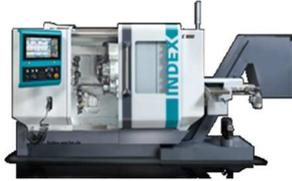
2-Spindel CNC-Drehmaschine für Stangenarbeiten,
