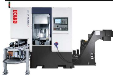
CNC-Drehmaschine für Futterarbeiten,
